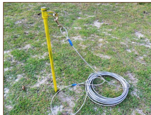
Figura 3: Haste de ferro com cabo de aço acoplado.
