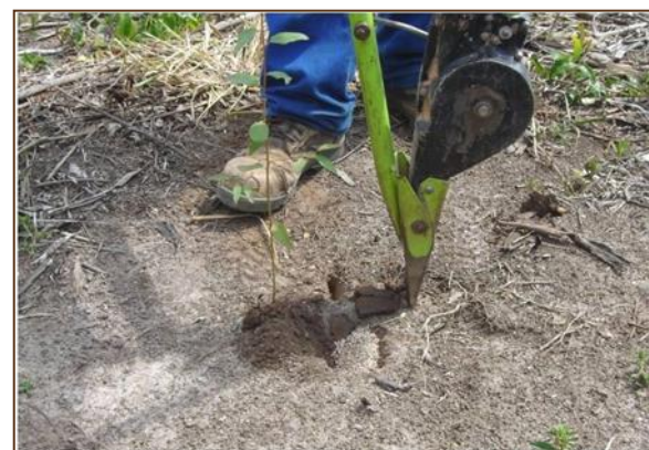
Imagem 6: aplicação de adubo em coveta lateral com adubadora manual.
