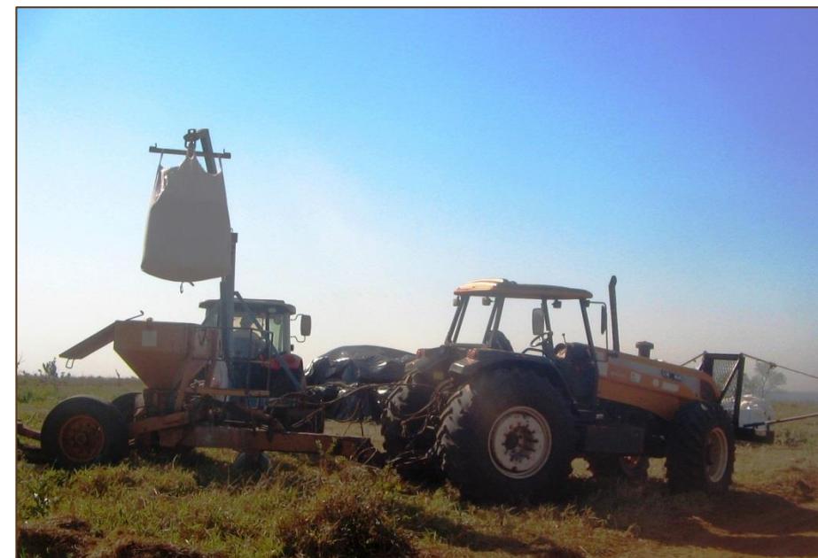
Imagem 5: Abastecimento do subsolador por implemento “pega-bag”.
